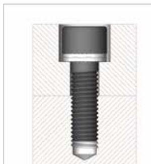
Tornillo cilíndrico asegurado en un agujero ciego
