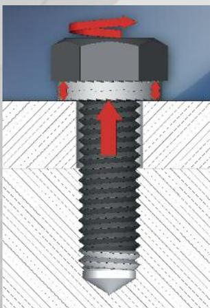
Una diferencia importante entre la arandela con seguridad HEICO-LOCK® respecto a otros sistemas es la fijación mediante tensión en vez de fricción
