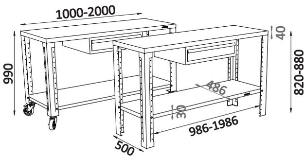
Banco de trabajo con bandeja inferior en chapa galvanizada y graduable en altura.
