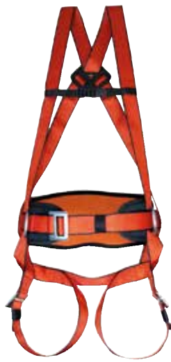
ARNÉS ANTICAÍDAS 302400027 CLIMAX 10 MAXIPRO. 2 puntos de anclaje anticaídas (dorsal y frontal). 1 de sujeción lateral, formado por dos hebillas abatibles. Cintura acolchada.
