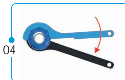
Apriete la tuerca del accesorio según indica la flecha
