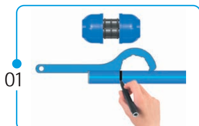
Medida para la inserción del tubo en el accesorio
