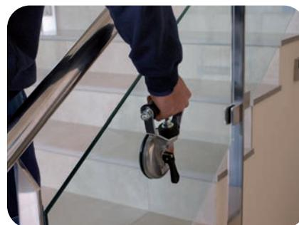
Las ventosas industriales presentan diferentes formatos de uso. Están diseñadas para facilitar la manipulación de materiales que, bien por su forma o tamaño, son poco manejables. Recuerde que no debe utilizar elementos de elevación unidos a las ventosas.
