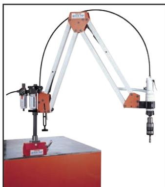
Soporte imantado colocado sobre una base metálica. Recuerde que ésta debe de tener un espesor de al menos 20 mm para asegurar la estabilidad del brazo.
