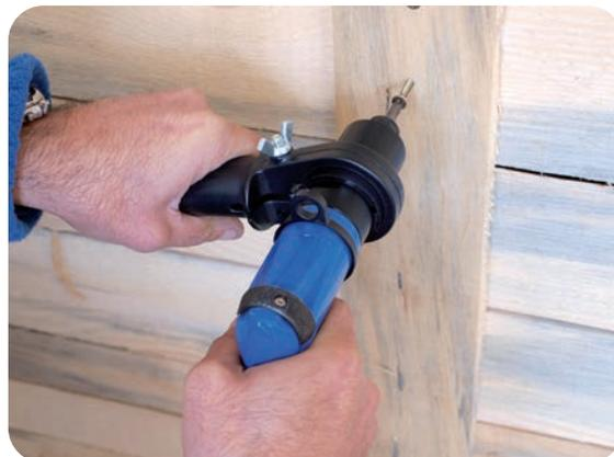
Este modelo de atornillador destaca por ser versátil y sencillo, ya que no necesita ajuste mecánico; su sistema directo se recomienda para montajes sobre madera, plásticos o similares.
