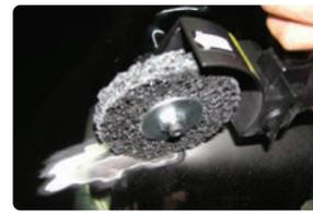
Con el disco de fibra abrasiva limpiaremos cualquier soldadura y eliminaremos óxidos y pinturas, en superficies planas.
