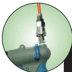
Entrada de aire superior. En este caso el gatillo queda anulado, produciéndose el arranque por presión de la punta sobre el tornillo. Sólo para las series YA CPP.
