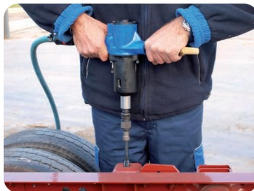
Esta roscadora está diseñada para realizar roscas en agujeros pasantes hasta M-16, incluso puede llegar a M-18 en materiales como aluminio, latón o similares. Su rendimiento está garantizado dada su considerable potencia y la calidad de sus componentes. Su doble empuñadura le otorga unas condiciones de trabajo seguras e inmejorables.
