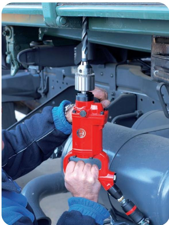
Este modelo de taladro de gran capacidad dispone de dos empuñaduras que permiten una buena sujeción para realizar trabajos en diferentes posiciones. Su capacidad hasta brocas de 16 mm. ofrece innumerables posibilidades en el sector del metal.
