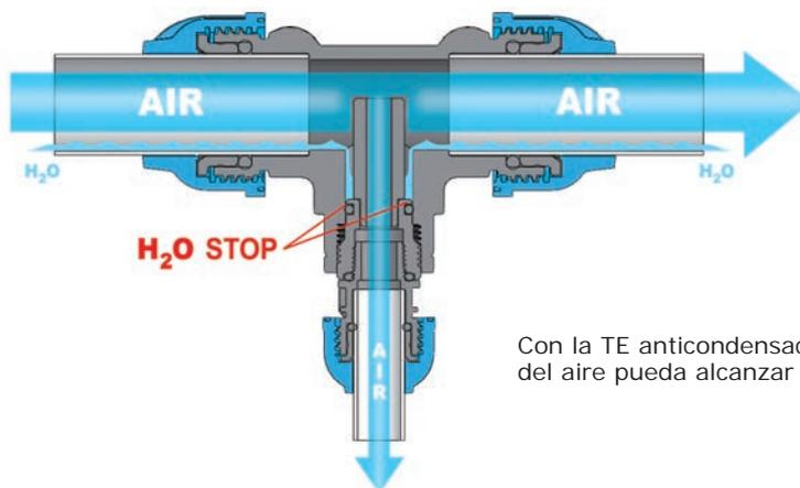
Con la TE anticondensación evitará que la humedad del aire pueda alcanzar la bajante de la línea.
