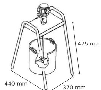
Estos agitadores con motor neumático de 250 W. de potencia garantizan un excelente rendimiento sobre líquidos de baja densidad.
