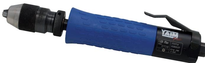
El diseño ergonómico de la empuñadura está pensado para proporcionar una sujeción cómoda de la herramienta a la vez que aísla térmicamente.
