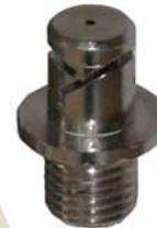
Boquilla sopladora antirrebote, su diseño le permite crear una cortina de aire protectora que desvía las virutas ligeras o fluidos en el caso de que salgan disparadas hacia el operario. Cumple con la normativa osha al desviar el aire en caso de obstrucción de la salida. Adaptable a pistolas sopladoras "KRIPIXE". Mod: SP, SN y R-17.
