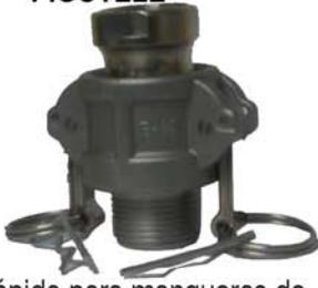
Conexión rápida para mangueras de producto densos. Facilita la conexión y desconexión de las mangueras sin usar herramientas y evitando que enrolle sobre si misma en cada giro. Compatible con todas las pistolas de presión "KRIPIXE" cuya entrada de material sea R. Gas 3/4. Mod: 780-G, 780-GL, 950-G, 2000-G.
