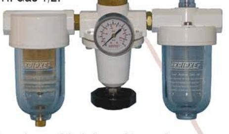
Regulador + filtro + lubricador para instalaciones neumáticas. Regula la presión de aire y la cantidad de aceite con la que se quiere que trabaje, además elimina las impurezas y la humedad del aire comprimido.
