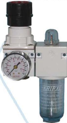
Regulador + lubricador para instalaciones neumáticas. Regula la presión de aire y la cantidad de aceite con la que se quiere que trabaje la maquina, a la que se conecta.
