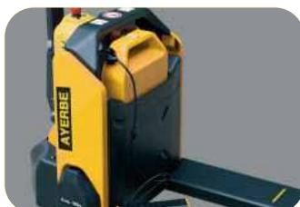
El enchufe de carga se coloca directamente sobre la batería, lo que evita tener que extraerla. Con carga rápida de sólo 2,5 horas
