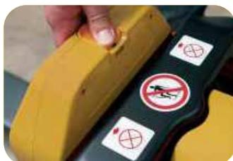
La batería se coloca muy fácilmente y queda perfectamente ajustada mediante un cierre que garantiza la seguridad. Peso de la batería 4,6 kg.
