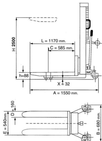
**APILADOR SEMI-ELÉCTRICO 1.000 KG. 1.600 mm.**
