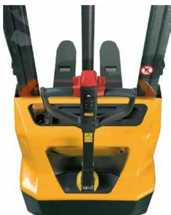
El operario ve siempre las palas incrementando así la seguridad
