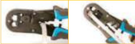
Corte de cables de red
