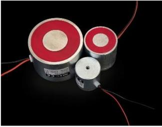
La atracción y la sujeción de las piezas ferromagnéticas es obtenida por imanes permanentes incorporados en la ventosa, con este tipo de ventosas eliminamos el problema de desprendimiento de la carga por fallo en la tensión de alimentación.
