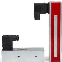
Este tipo de electroimanes se fabrica con aleaciones férricas y funcionan a 24 V corriente continua. Bajo pedido, también se pueden fabricar en corriente alterna. Su funcionamiento es muy sencillo: cuando se activa la corriente, se genera un campo magnético que queda concentrado en la armadura de hierro, permitiendo así cualquier tipo de sujeción.
