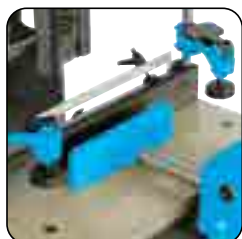
2 prensos verticales de apriete rápido y 1 prensor horizontal deslizante
