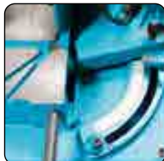
Arco orientable de 0° a 60° a la izquierda para los cortes angulados
