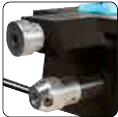
Carro lateral y longitudinal en cola de milano
