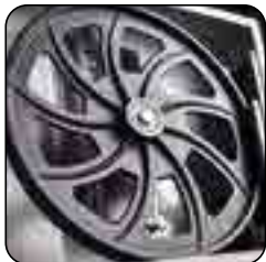
Volantes de acero fundido equilibrados
