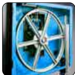
Volantes de aluminio fundido equilibrados y contactores de seguridad
