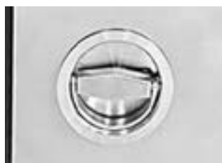
Maneta de apertura integrada en el cuerpo
