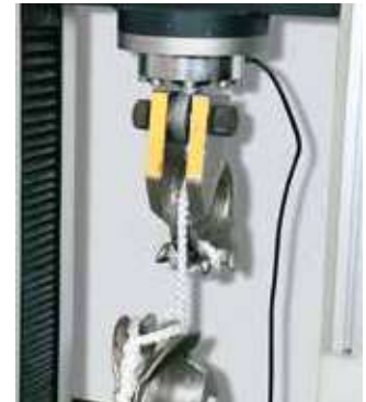
Test cuerda Rope test
