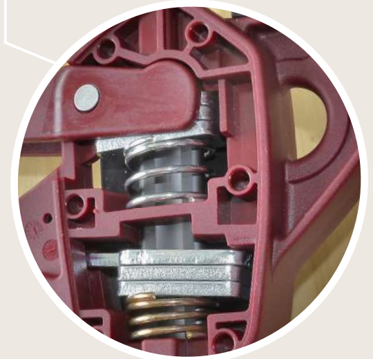
Juego de 6 pletinas de acero para el freno y el avance 6 steel plate set to advance and brake
