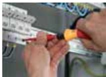
**Juego de destornilladores dinamométricos TorqueVario®-S electric en surtido, de 18 unid., con limitación del par de apriete de ajuste variable, en bolsa**
