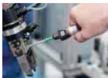
**Destornillador dinamométrico iTorque® con escala digital**
